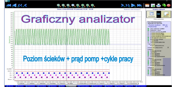
Mapka umożliwia szybka analizę statusu monitorowanych przepompowni
